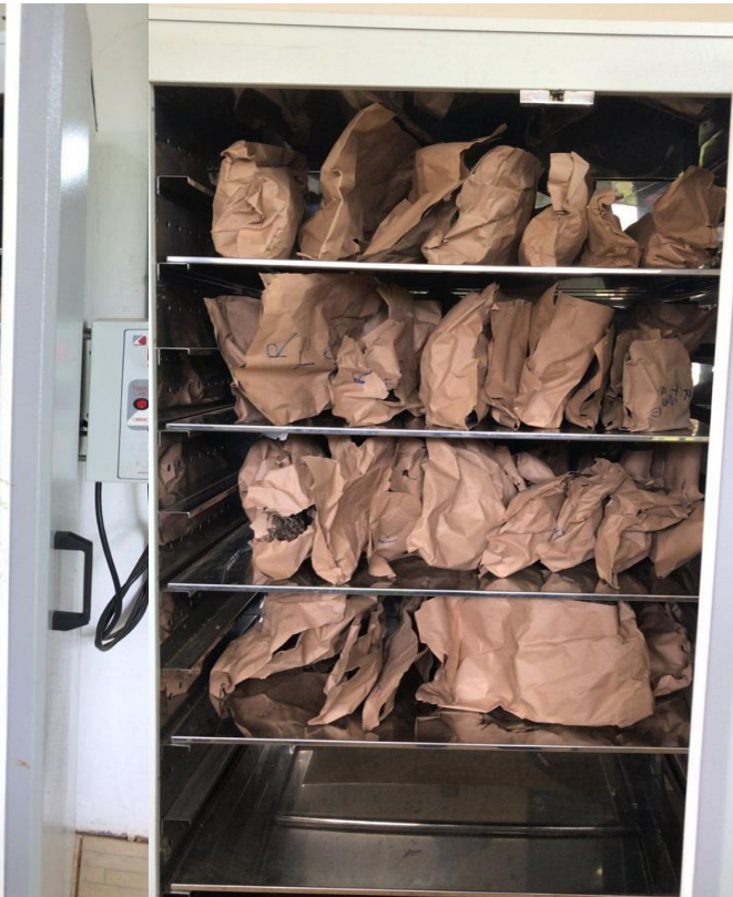
Secagem em forno a 65°C por 4 dias
