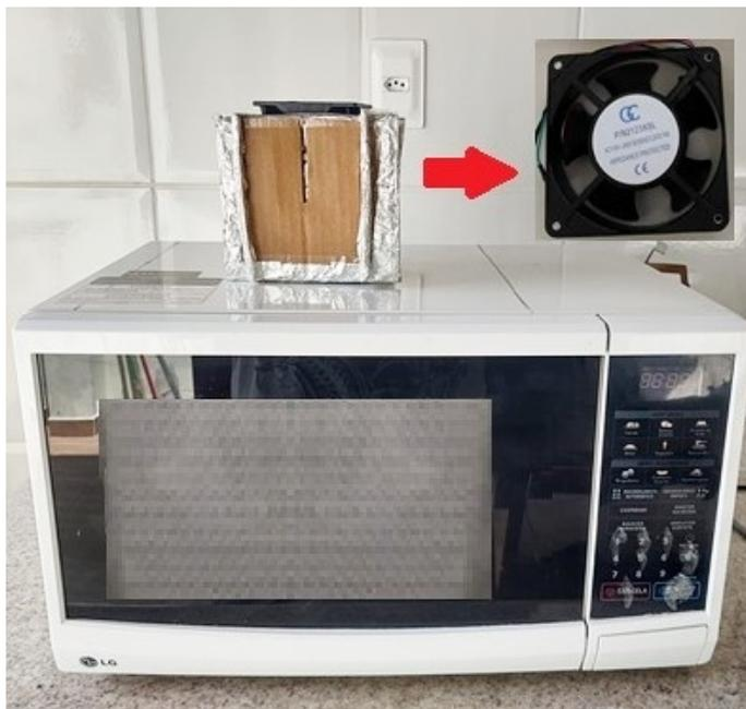
Figura 7. Micro-ondas com exaustor adaptado no topo, utilizado para os ensaios de secagem
