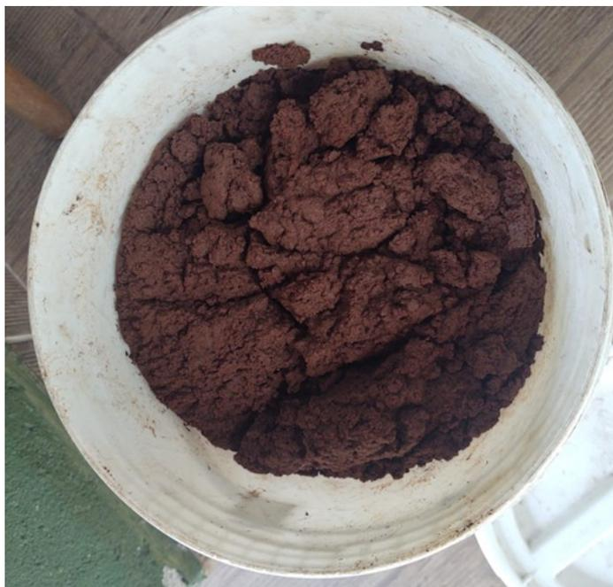
Figura 5. Amostra de lodo coletada na ETA de Barra Velha, após desaguamento por prensa parafuso.
