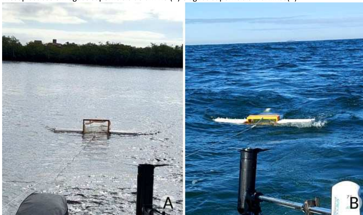
Figura 5: Dinâmica do funcionamento da Tecnologia de Rede de Baixo Custo para microplásticos e mesoplásticos em águas superficiais de um rio (A) e águas superficiais marinhas(B).
