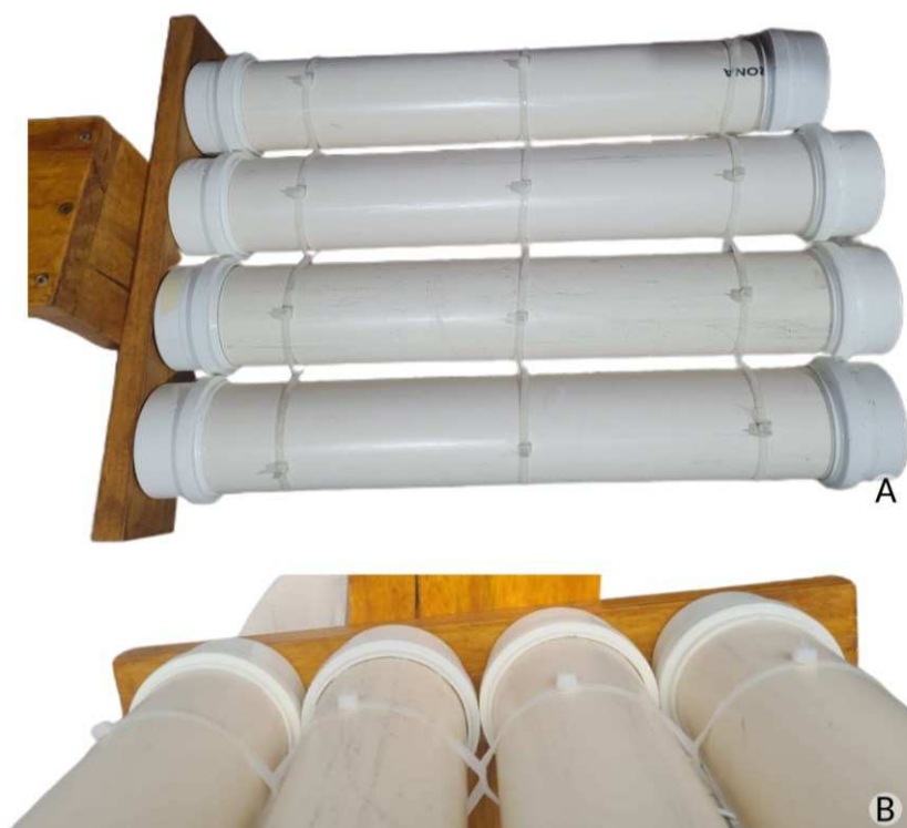
Figura 4: Aspectos do sistema de flutuabilidade em PVC da Rede de Baixo Custo responsáveis pela estabilidade do sistema em águas superficiais (A). Destaque para as abraçadeiras entrelaçadas entre os canos de PVC para maior resistência (B).
