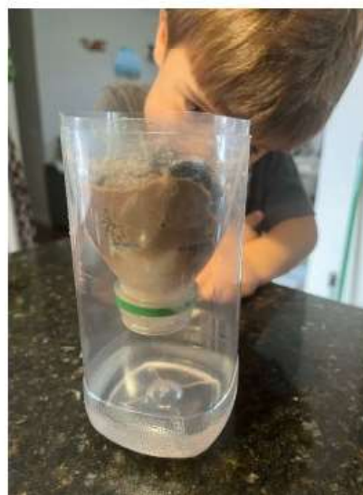
Figura 25: Montagem do filtro
